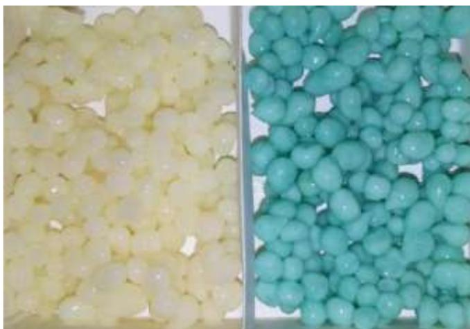
Рисунок 43 - Фотографии гранул криогелей ПВС-ХТО до и после сорбции ионов  $\text{Cu}^{2+}$ .
